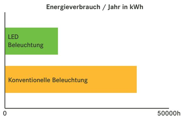
\* Vergleich basiert auf CDM-T 70 Watt (KVG) zu LED Stromschienenstrahler - 38W
