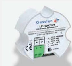
LED-Treiber mit Überwachungsbausteins zum Einbau in eine bestehende Geräte-Verbindungsdose mit Norm-Kombinationsabstand von 71 mm gemäß DIN 49073-1 (tiefe Ausführung)
