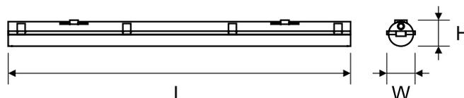
Die Leuchten sind nicht zur Montage an Orten bestimmt, die Witterungseinflüssen ausgesetzt sind, in Autowaschanlagen, in Räumen, in denen mit Hochdruckreinigern gearbeitet wird, in Tierlokalen, in aggressiven Umgebungen usw. Lichtstrom-Toleranz +/- 10%. Leistung-Toleranz +/- 5%.
