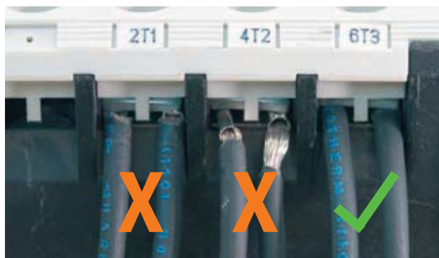
Bild 6: Richtiges und falsches Auflegen der Leitungen
