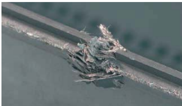
Bild 12: Beispiel für Beschädigungen der Dichtlippe von Gehäusen
