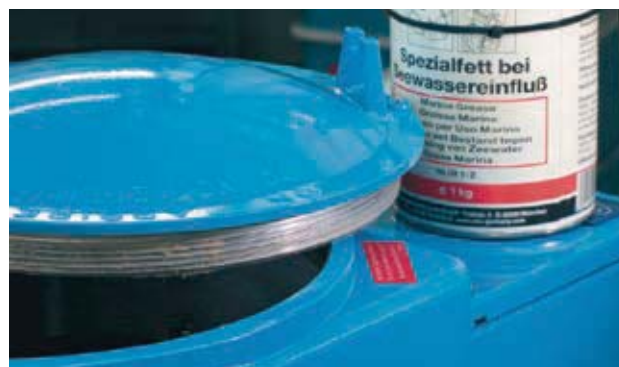
Bild 9: Verwendung von korrosionshemmenden Fett
